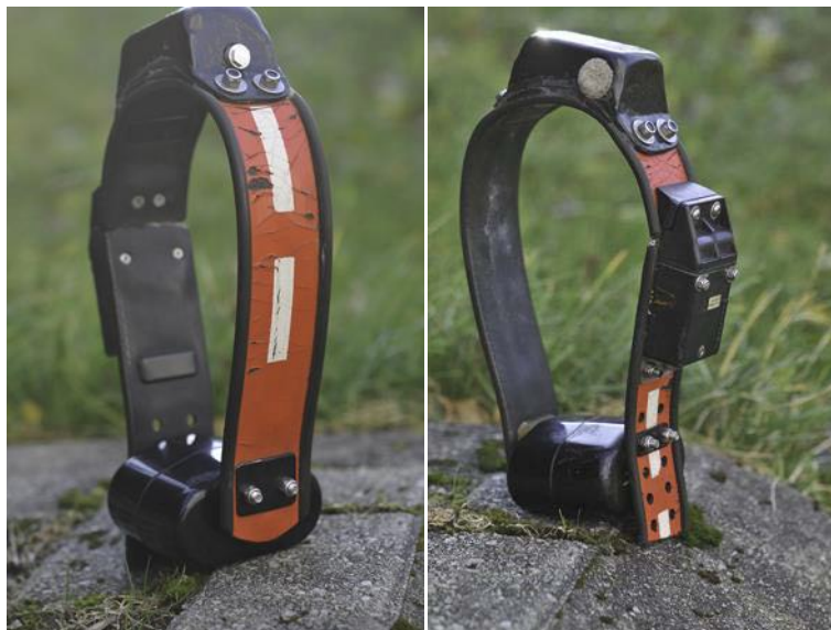
Figur 9. Foto av GPS-sender fra VECTRONICS og som er brukt i dette prosjektet. Antennen for satellitt og GSM-signaler sitter i kapselen på toppen av senderen, batteriet i den nederste ovale kapselen. Legg også merke til nummereringen på halsbåndet og den elektroniske utløserenheten på bildet til høyre som seinere er supplert med en bruddsone i bomull.
