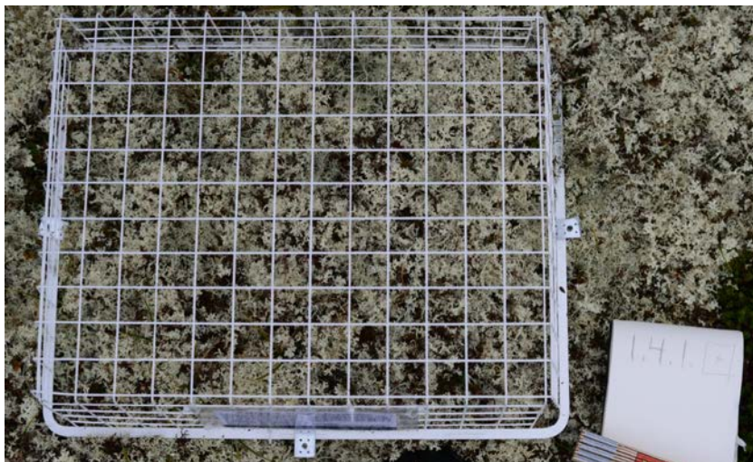
Figur 3.6.1.2. Beite-ekskluderingskurv plassert over prøveflate 1.4.1 (dvs. transekt 1, lokalitet 4, prøveflate 1). Kurven skal hindre at reinen beiter i prøveflata.
