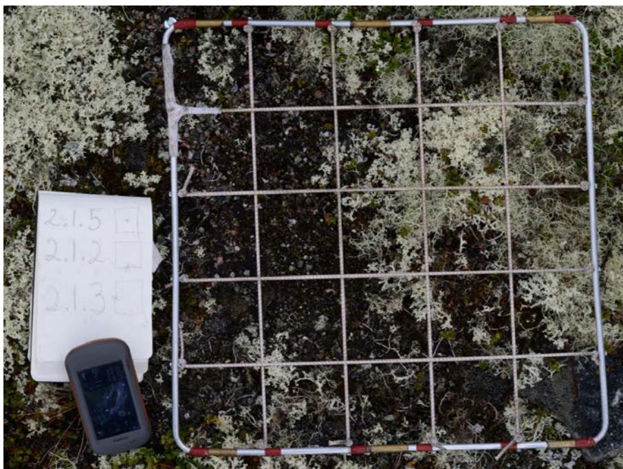
Figur 3.6.2.1. Måle-rammen plassert over prøveflate 2.1.3 (dvs. transekt 2, lokalitet 1, prøveflate 3). Her er dekningsgraden av lav anslått til 38 %, potensiell dekningsgrad 56 %, og lavhøyden 30 mm.
